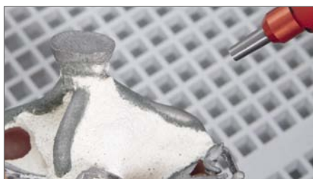
Retirada sencilla de material de revestimiento
