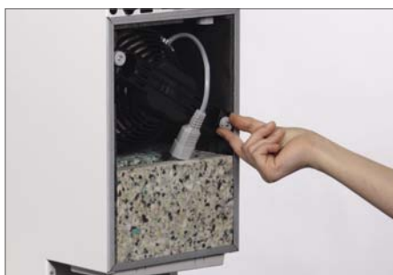
3º paso: desenchufar el motor y soltar los tornillos
