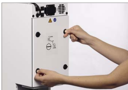
1º paso: desenclavar la cubierta
